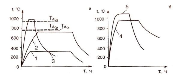
Рис. 1. График термообработки сварных соединений из стали  $12X1M\Phi$  (a) и хромоникелевой (нержавеющей) стали 12X18H9T: 1 — термический отдых; 2 — высокий отпуск; 3 — нормализация; 4 — стабилизирующий отжиг; 5 — аустенизация;  $T(A_{c1})$ ,  $T(A_{c3})$  — температуры критических точек структурных изменений.
