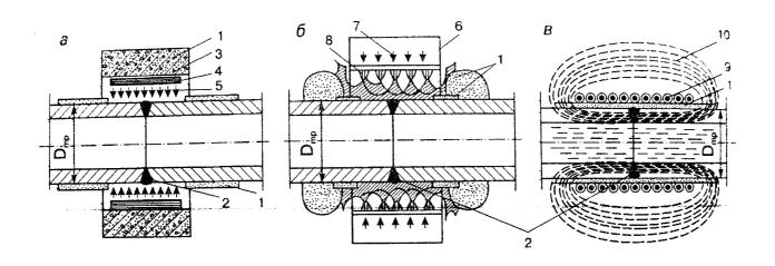
Рис. 2. Схема нагрева сварных соединений при местной термообработке: электронагревателем сопротивления (а); газопламенным нагревом (б); индукционным способом
